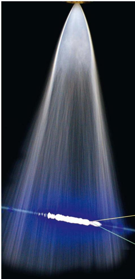
Die DIN SPEC 91325 legt ein Verfahren zur Messung der Tropfengröße fest. Hierfür sind Leitlinien zur Messung der Größe nahezu sphärischer Tropfen definiert worden. Quelle: AOM-Systems
